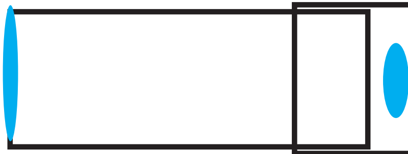
Фиг.12: Схема на телескопа на Кеплер
